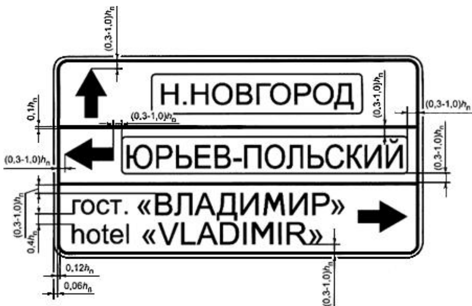
Рисунок Г.4 - Пример компоновки знака индивидуального проектирования 6.10.1
