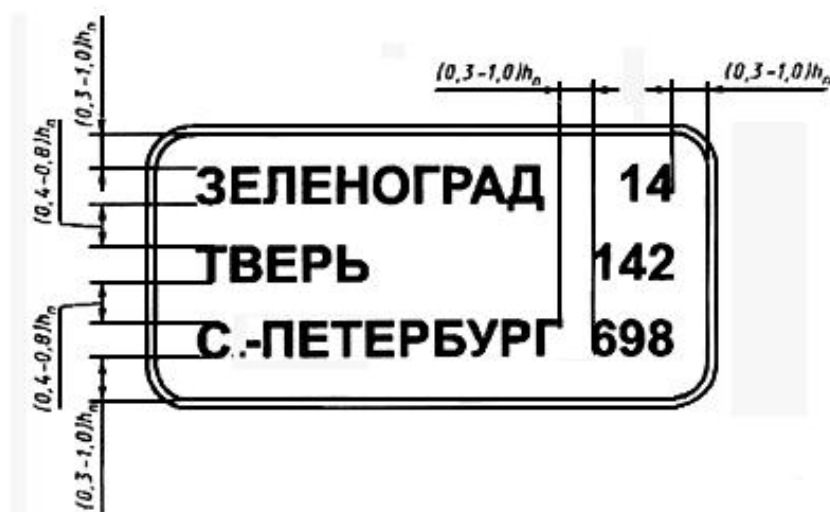
Рисунок Г.5 - Пример компоновки знака индивидуального проектирования 6.12
