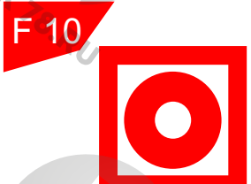
Кнопка включения установок пожарной автоматики
