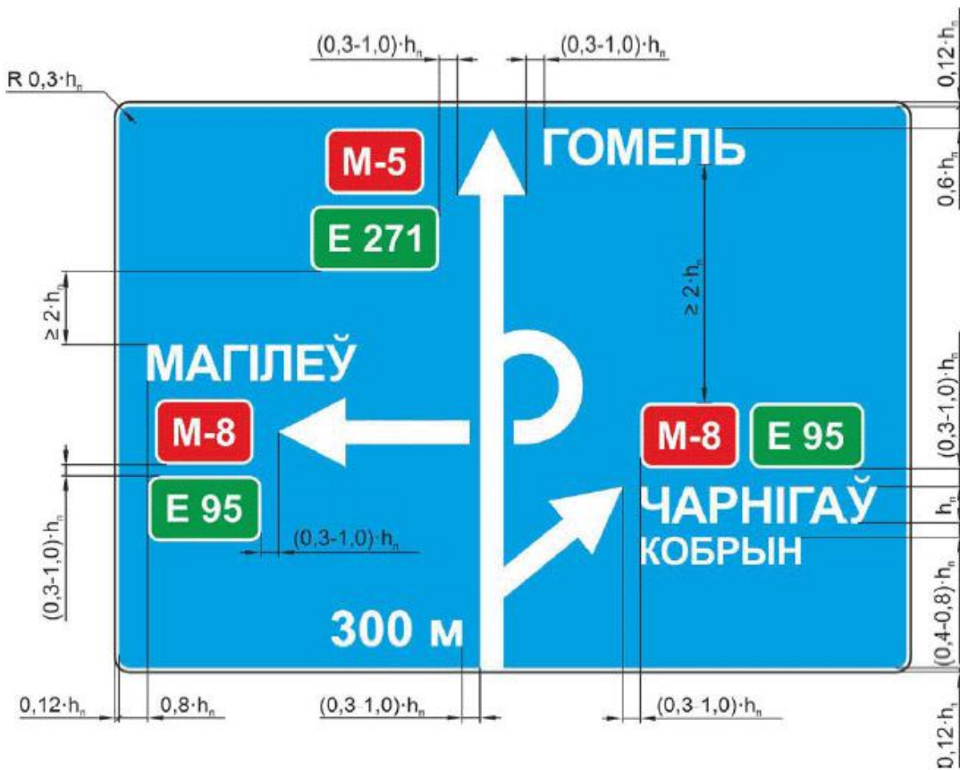
Рисунок В.1 - Пример компоновки изображения знака вида 27
