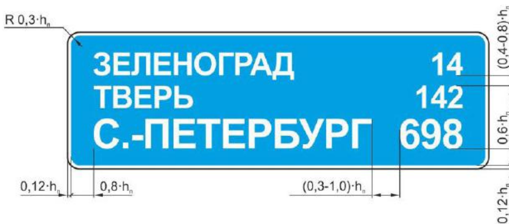
Рисунок В.5 - Пример компоновки изображений знака вида 36
