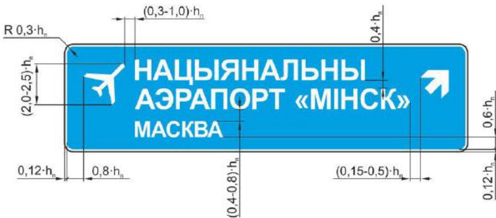
Рисунок В.2 - Пример компоновки изображения знака вида 29
