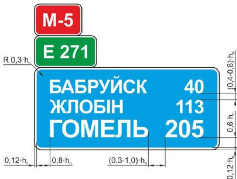
Рисунок В.6 - Пример компоновки изображений знаков видов 36 и 37 (38)
