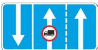
Рисунок 1 - Пример расположения запрещающего знака на знаке "Направление движения по полосам"
